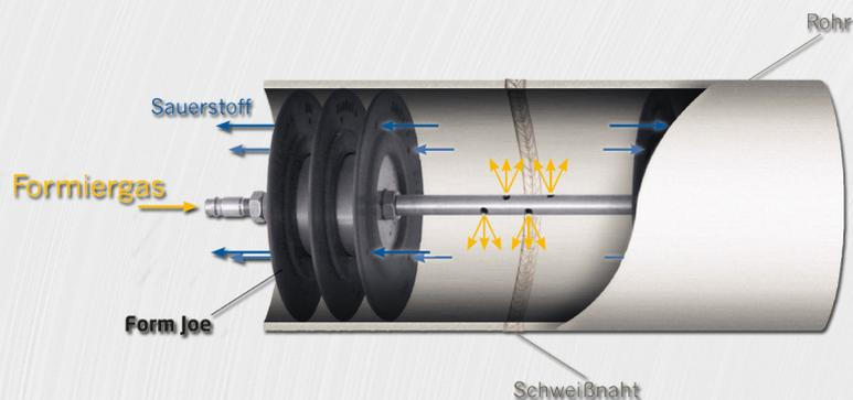
Das System ist in allen Variationen einsetzbar. Ob für T-Stück, Abzweiger, Hosenstück, Bogen, Flansch, Bördel oder für alle unterschiedlichen Rohrdurchmesser. Die „Form Joe“ ist ein aus der Praxis entwickeltes Produkt.
